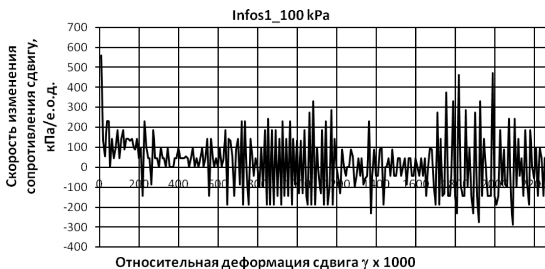
Рисунок 6 – График изменения сопротивления образца сдвигу при нормальном давлении 100 кПа
