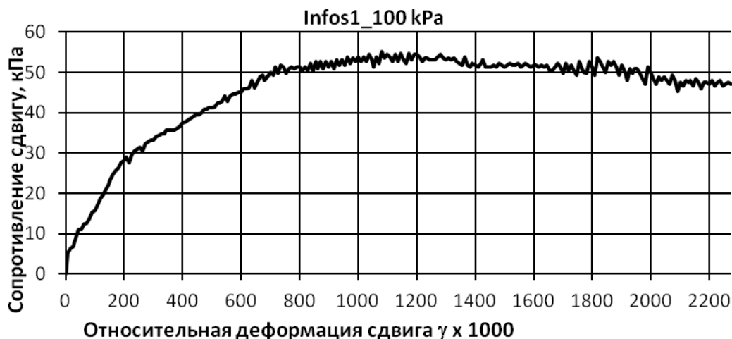
Рисунок 5 – График сопротивления образца сдвигу при нормальном давлении 100 кПа
