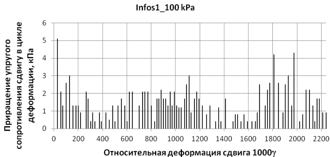
Рисунок 8 – Приращения сопротивления образца на восходящей ветви цикла
