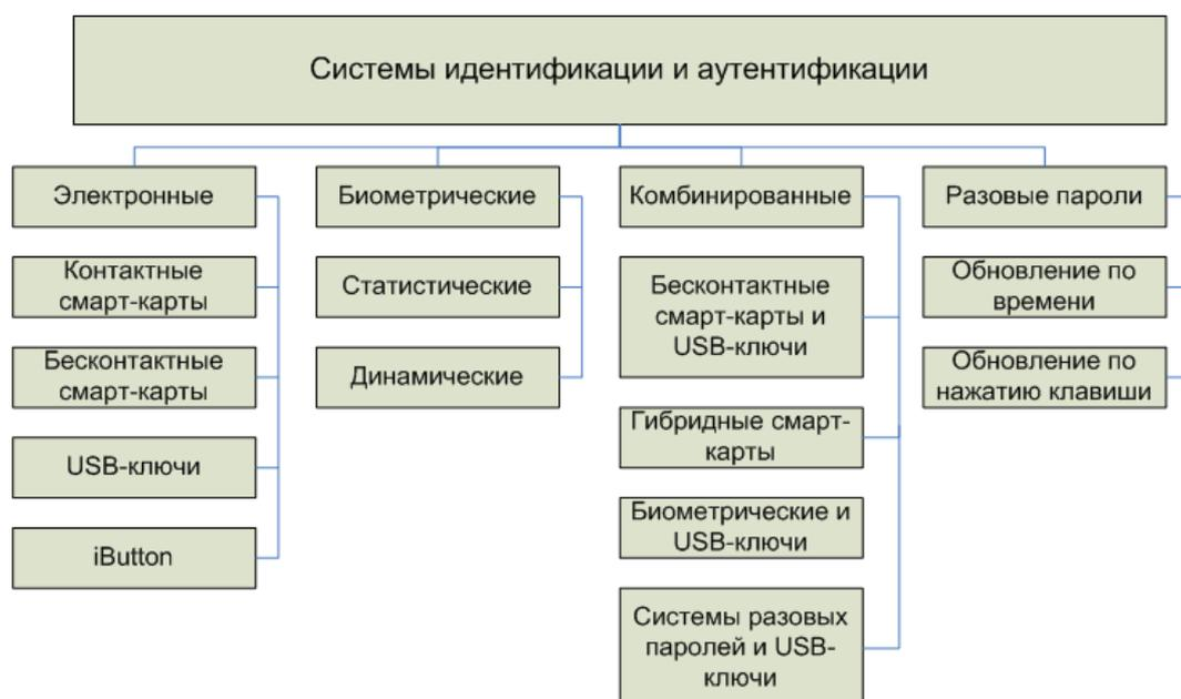
Рисунок 2 – Классификация программно-аппаратных систем идентификации и аутентификации
