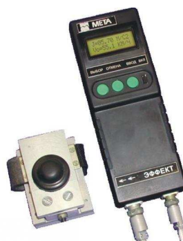
Рисунок 7. Прибор «Эффект» для бортового диагностирования тормозных свойств автомобилей
