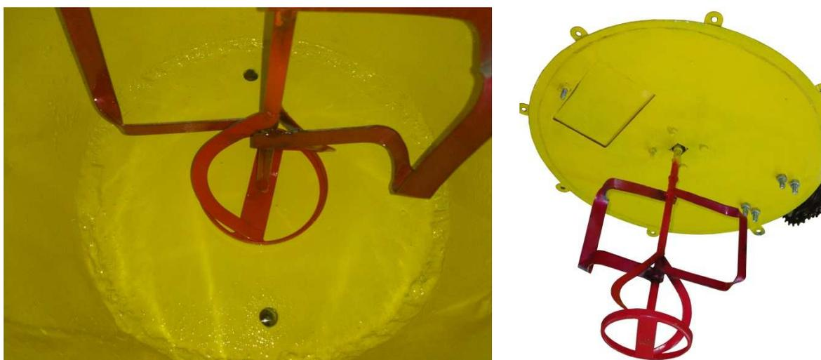
Рисунок 11 – Мешалка гидросеялки ГНОМ-2
