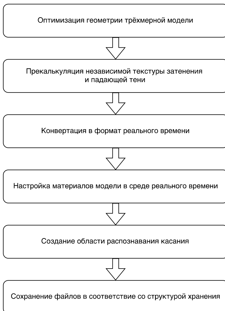
Рисунок 7 – Методика подготовки трёхмерной модели
