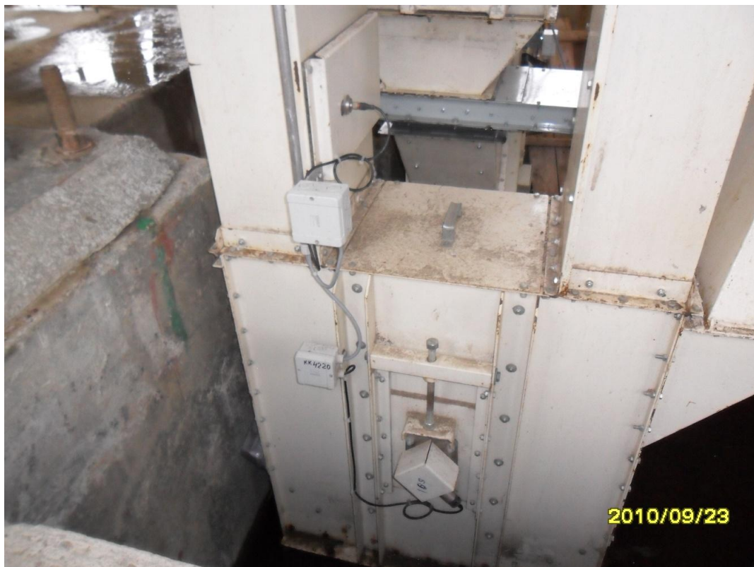
Рисунок 4 – Нория, оснащенная датчиком РКС и датчиком контроля смещения ленты. Изготовитель: фирма «ifm electronic GmbH» (Германия)
