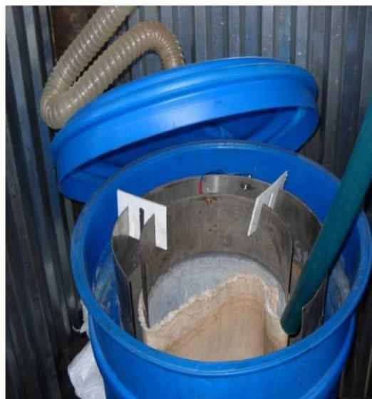
Рисунок 2. Реактор с установленными электродами и ионопроницаемой диафрагмой
