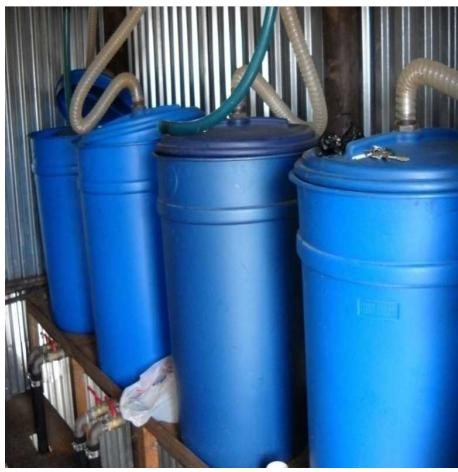
Рисунок 3. Обвязка емкостей установки
