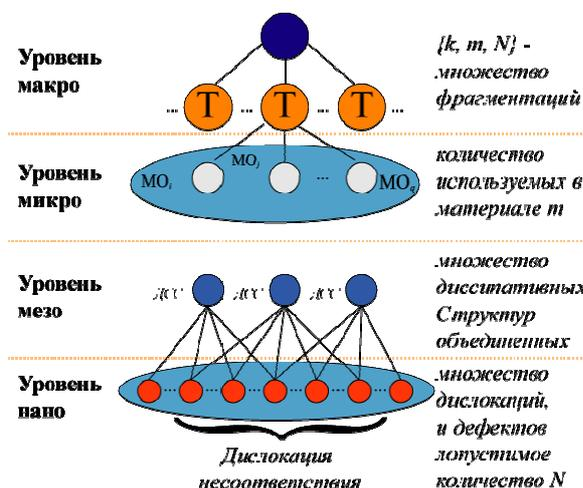
Рисунок 1- Пример иерархической системы моделирования разрушения [3]
