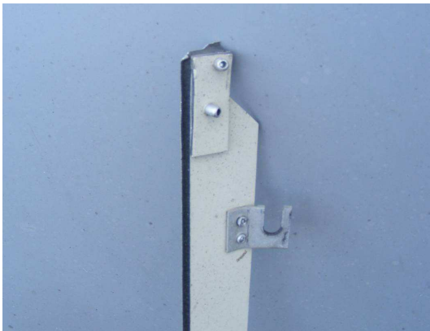
Рисунок 12– Элемент разрушенной композитной панели – вертикальное ребро с иклей
