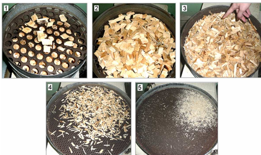
Рисунок 4 – Результаты лабораторного отсева: 1 – крупная некондиционная щепа; 2 – крупная кондиционная щепа; 3 – мелкая кондиционная щепа (с примесями некондиционных частиц); 4 – некондиционная фракция («иголочки»); 5 – мелкая некондиционная фракция (опилки и пыль) [7].
