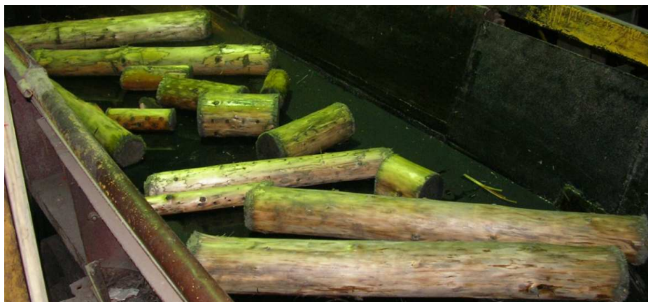
Рисунок 1. – Короткомеры в потоке очищенных от коры балансов [7]
