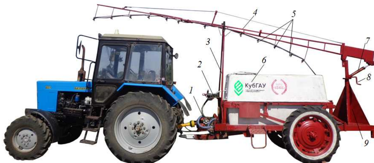
Рисунок 8 – Модернизированный опрыскиватель опрыскиватель ОП-2000: 1 – насос; 2 – регулятор давления; 3 – подставка; 4 – штанга; 5 – распылители; 6 – бункер; 7 – гидроцилиндр; 8 – рукоятка; 9 – опора
