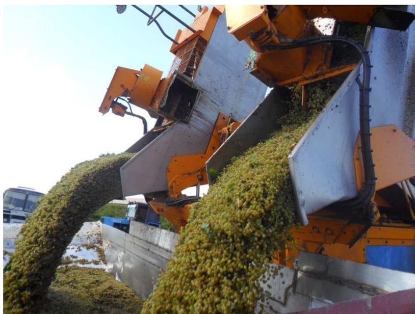
Рис. 8. Выгрузка винограда из бункеров виноградоуборочного комбайна New Holland Braud 9000L в лодочку
