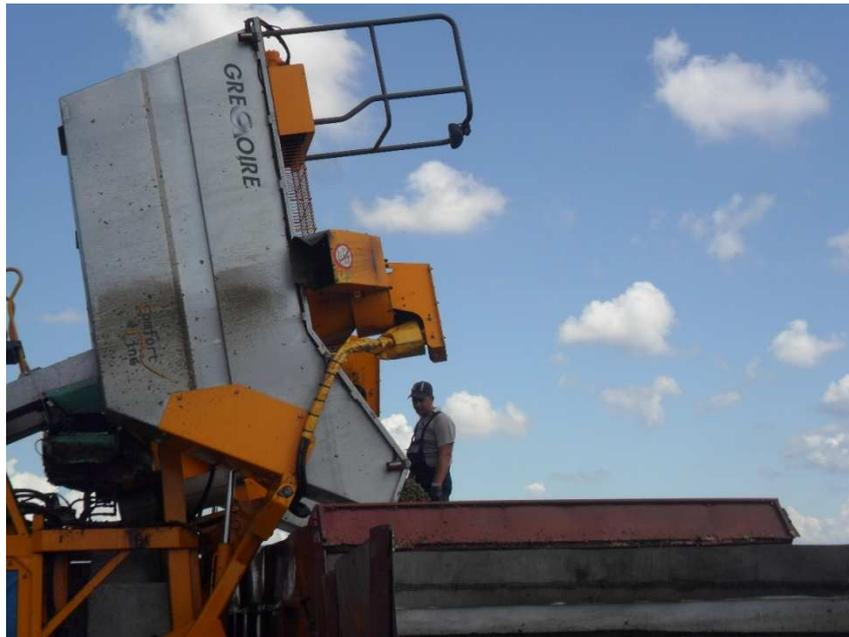
Рис. 9. Выгрузка винограда из бункера комбайна Gregoire G–152 в автомобильную лодочку
