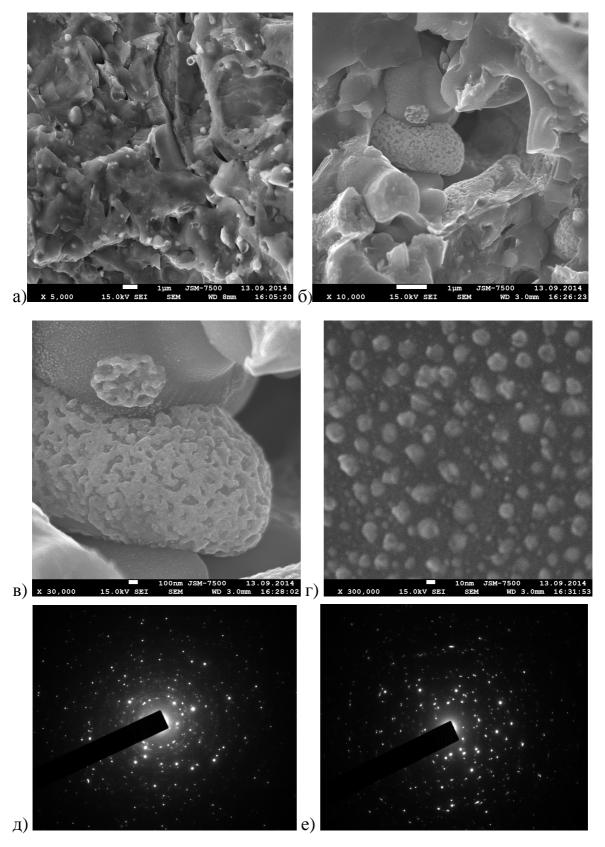
Рис. 5. Наноструктурированное покрытие TiNiCo, полученное  $B\Gamma H - a$ -г; микроэлектронограммы аустенитной B2 и мартенситной B19' фазы, фаз  $Ti_2Ni$ ,  $Ni_3Ti$ ,  $Ni_4Ti_3$  с небольшими включениями оксида титана – д,е)
