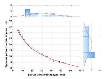
Рис. 2. Влияние времени механоактивации на размер частиц порошка TiNiCo (ПН48.5Т50К1.5), активатор  $\Gamma$ ЕФЕСТ-2 (А $\Gamma$ О-2Y)
