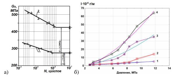
Рис. 10. Кривые выносливости стали 45: без покрытия (1), после поверхностного модифицирования TiNiCo (2) — а); зависимость интенсивности изнашивания I от давления диска P: скорость скольжения диска 0,5м/с -1; 1 м/с -2; 1,5 м/с -3; 2 м/с -4— б)
