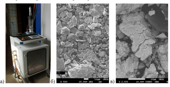
Рис. 1. Установка высокоскоростного газопламенного напыления – (a); морфология частиц порошка марки ПН48.5Т50К1.5 - (б,в)
