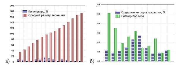
Рис. 6 Количественное распределение размера зерен (а) и пор (б) и их процентное содержание в покрытии TiNiCo
