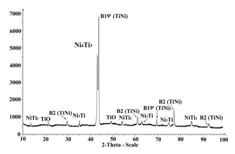
Рис. 4. Рентгенофазовый анализ сплава *TiNiCo*, после ВГН
