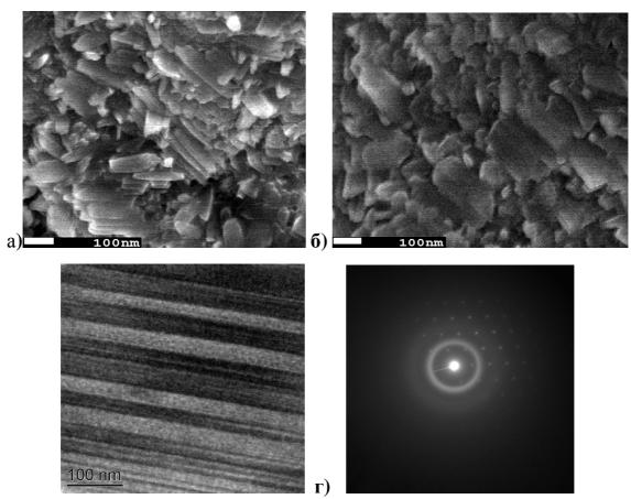
Рис. 9. Микроструктуры слоя TiNiCo после TMO: a)  $-\times45000$ ; б)  $-\times50000$ ; c)  $-\times80000$ ; микроэлектронограмма сплава TiNiCo после TMO - г)
