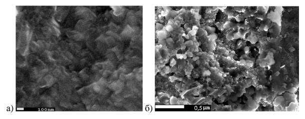
Рис. 8. Микроструктура покрытия TiNiCo после термической обработки (отжиг при  $T=873^{\circ}C$ ).  $\times 50000 - a$ );  $\times 35000 - b$ )
