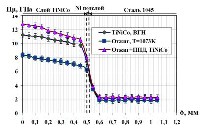
Рис. 7 Распределение микротвердости поверхностного слоя Ni-TiNiCo, полученного ВГН на стали 45,  $\delta_{TiNiCo}$ =0,5 мм
