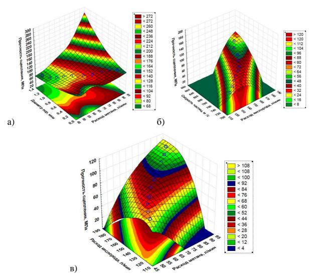
Рис. 3. Влияние состава горючих газов на прочность сцепления покрытия TiNiCo с основой
