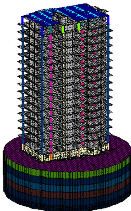
Рисунок 2 – Расчетная 3D - модель
