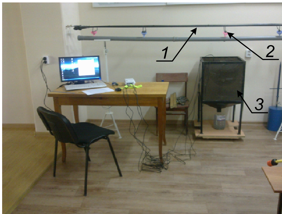
1 – водовод; 2 – капельница; 3 – ёмкость для почвогрунта
