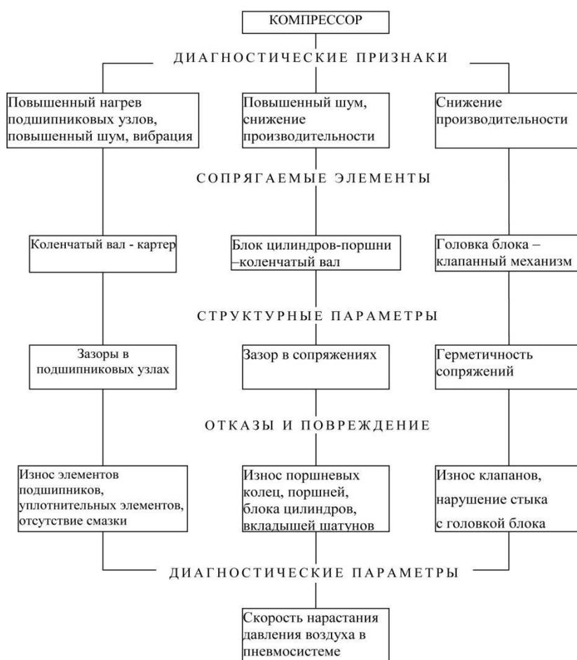
Рисунок 3. - Структурно-следственная модель тормозной системы
