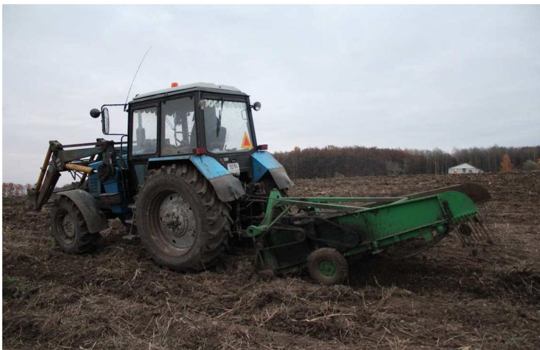
Рисунок 4 – Общий вид усовершенствованного картофелекопателя КТН-2В на делянке опытной агротехнологической станции ФГБОУ ВПО РГАТУ
