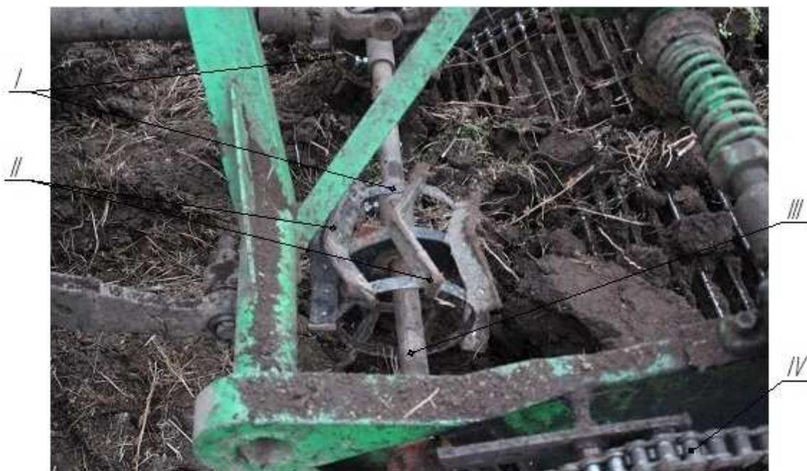
Рисунок 5 – Разработанное средство интенсификации сепарации:
