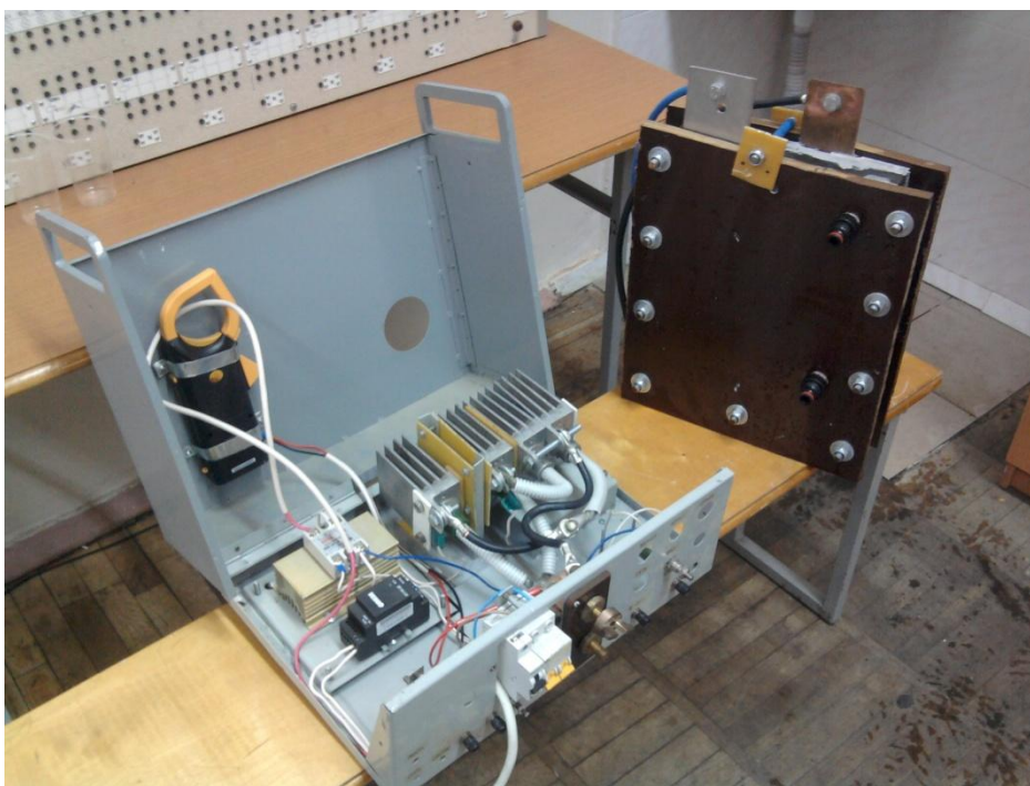
Рисунок 8 – Макетный образец электроактиватора и система управления
