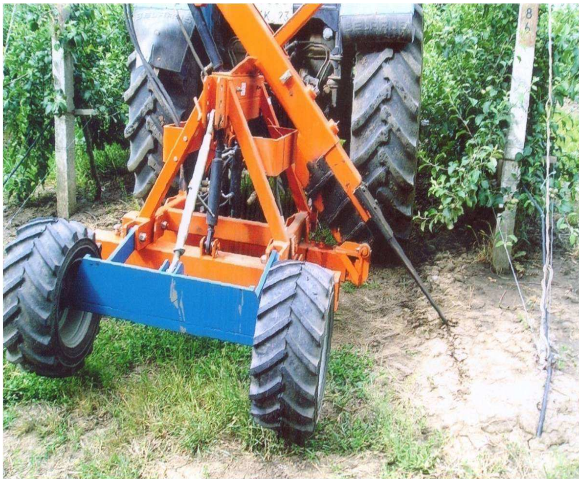
Рисунок 4. Определение расстояния, угла наклона и глубины подрезки корней плодовых деревьев
