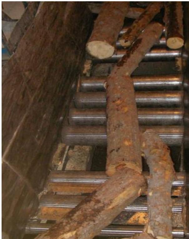
Рисунок 5. Провалочные окна на транспортере для удаления короткомеров
