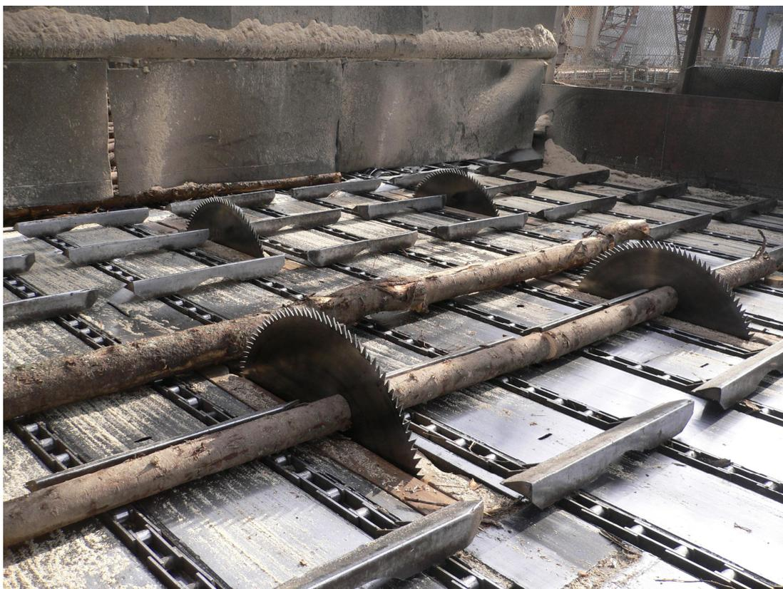
Рисунок 4. Слешерная установка с четырьмя пилами
