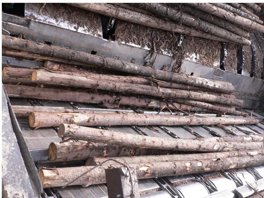
Рисунок 3. Круглые лесоматериалы на разобщике бревен перед подачей на слешерную установку
