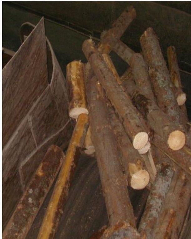
Рисунок 6. Балансы на поворотном участке конвейера, прошедшие провалочные окна
