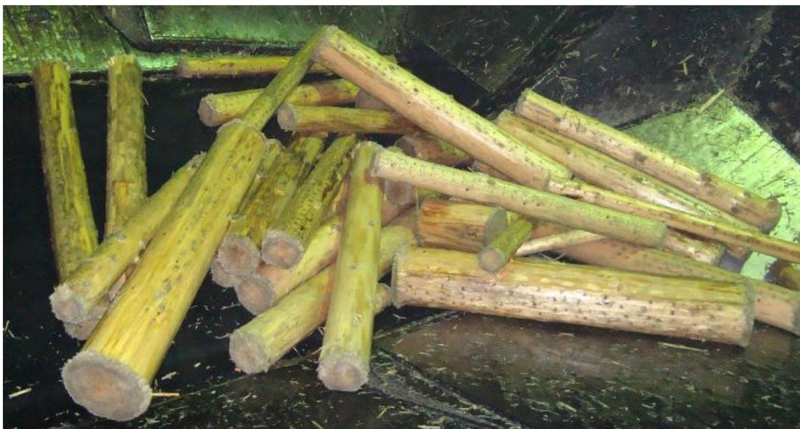
Рисунок 7. Повреждения древесины после очистки в корообдирочном барабане
