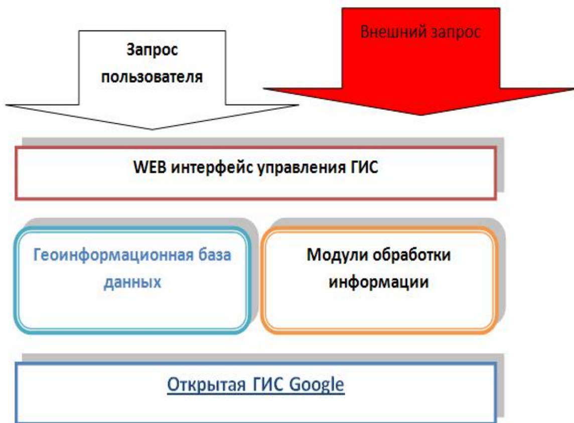
Рисунок 1 – Схема информационной системы экологического мониторинга
