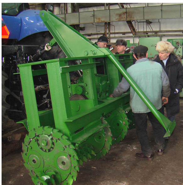
Рис. 12. Роторно-фрезерный почвенно-мелиоративный плуг с активной редукторной стойкой привода, 2008 г.
