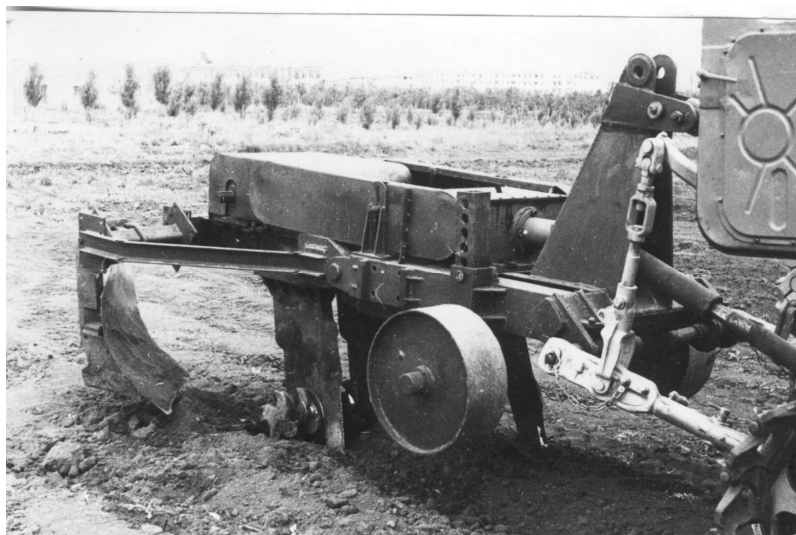
Рис. 5. Устройство для почвенно-мелиоративной ротационной фрезерной обработки почвы ПМС-70 в процессе погружения в почву.
