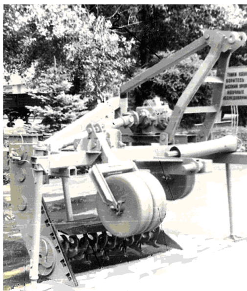
Рис. 7. Почвенно-мелиоративное роторное фрезерное устройство ФС-1,3 для подпокровной обработки почв.
