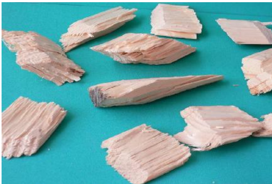
Рисунок 4. – Частицы измельчённой древесины, полученные в рубительной машине из баланса с окрашенной до измельчения торцевой частью. В центре рисунка показана частица, полученная при измельчении торцевой части баланса
