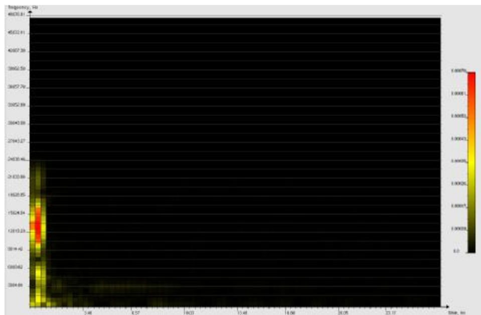
Рисунок 7. Спектрограмма ЭМ импульса, возбуждаемого образцом кварца при ударном воздействии
