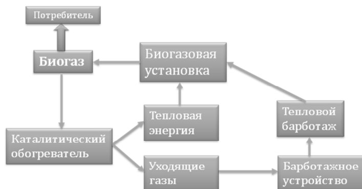
Рисунок 1 - Схема использования каталитических устройств сжигания для обогрева биогазовой установки
