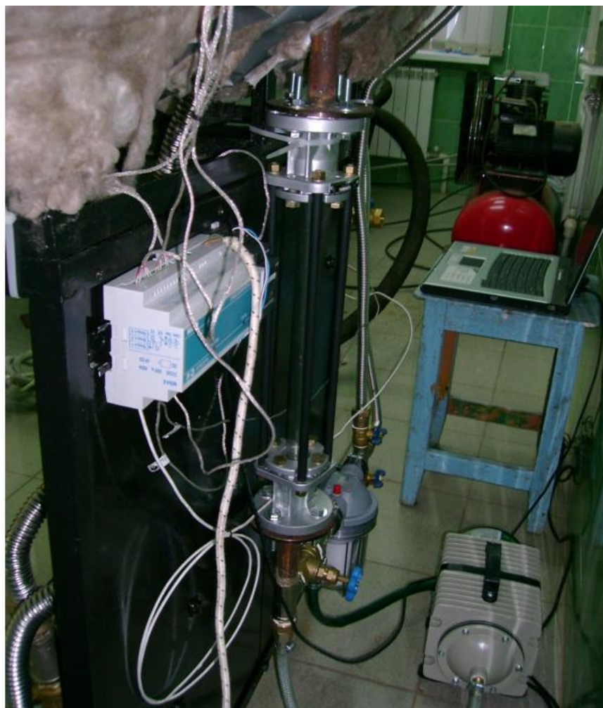
Рисунок 3 - Натурно реализованный биореактор с системой барботажного перемешивания и каталитического обогрева
