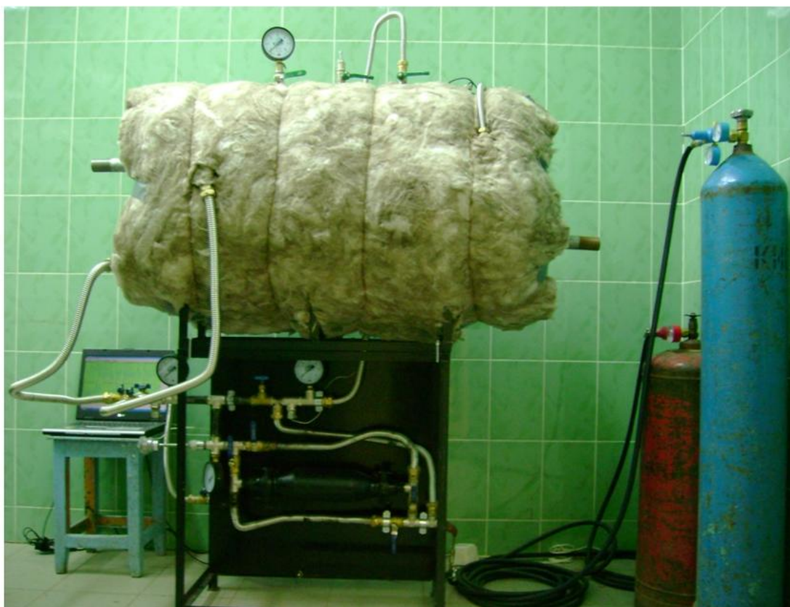
Рисунок 2 - Натурно реализованный биореактор с системой барботажного перемешивания и каталитического обогрева
