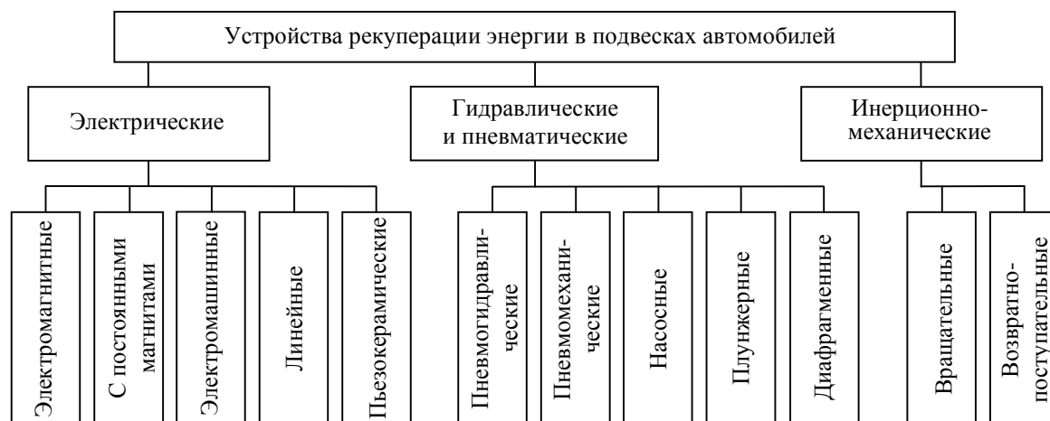
Рис. 2. Классификация устройств рекуперации энергии подвески автомобиля по виду рекуперированной энергии и типу конструкции
