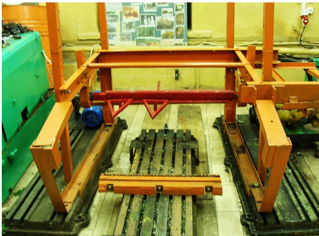
Рис. 2. Внешний вид лабораторной установки для оптимизации параметров кустореза новой конструкции
