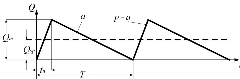
Рисунок 2. График изменения запасов в производственных условиях
