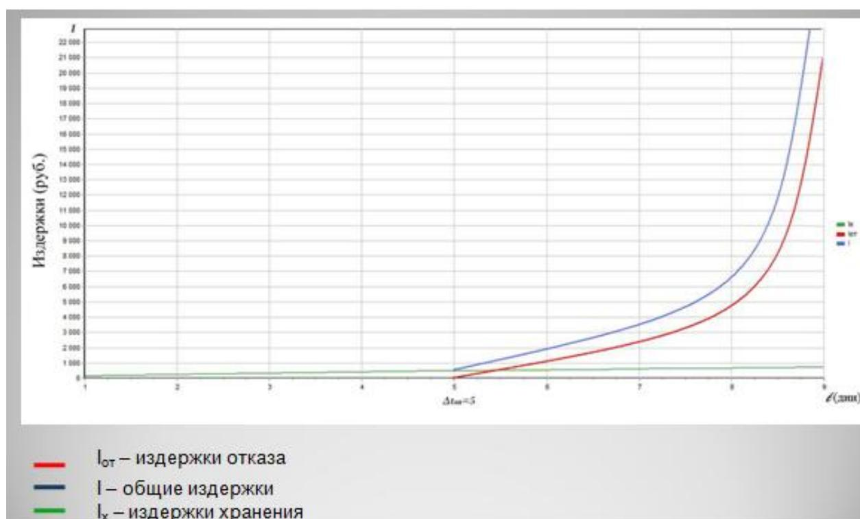
Рисунок 4. График для определения оптимального интервала упреждающей поставки очередной партии ( $\Delta t_{оп}$ ).
