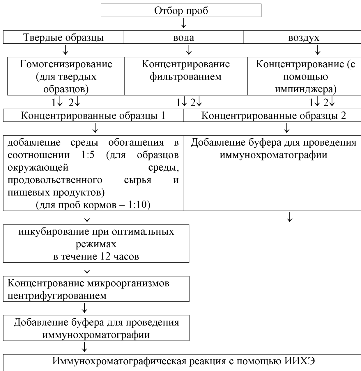
Рис. 1. Схема индикации микроорганизмов с помощью иммунохроматографии
