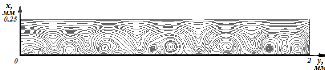
Рисунок 3 – Линии тока раствора электролита, рассчитанные спустя 100 секунд с момента включения электрического тока при скорости прокачивания раствора V_0 = 10^{-5} м/с и скачке потенциала d_\varphi = -0.45 В а) гладкий канал, б) канал с кавернами и в) со вставками с учетом электроконвекции, соответственно.
