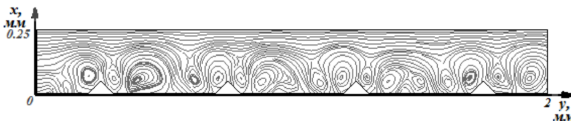
Рисунок 4 – Линии тока раствора электролита, рассчитанные спустя 100 секунд с момента включения электрического тока при скорости прокачивания раствора V_0 = 10^{-4} м/с и скачке потенциала d_\varphi = -0.45 В. а) гладкий канал, б) канал с кавернами и в) со вставками с учетом электроконвекции, соответственно.
