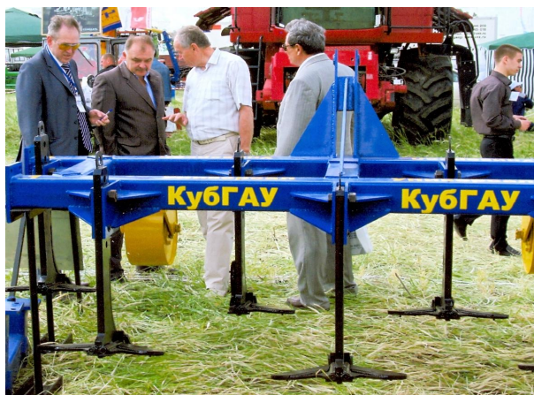
Рисунок 1 – Экспериментальный образец «Универсального плуга для безотвальной обработки почвы»
