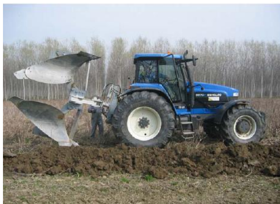
Рис. 3. Оборотный плуг итальянского производства FS.1/94.
