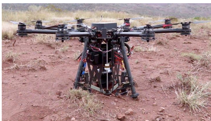
Рисунок 3 – Беспилотный летательный аппарат с функцией непосредственного зондирования проб почвы
