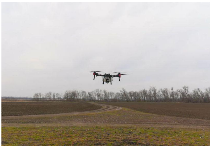
Рисунок 2 – Беспилотный летательный аппарат для опрыскивания полей в период фунгицидной обработки
