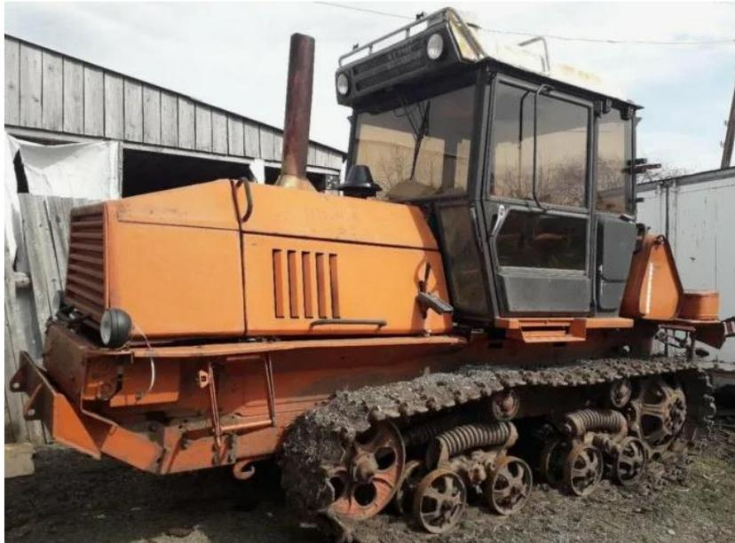
Рисунок 2 – Трактор ВТ-100Д, выработавший свой технический ресурс до 1-го капитального ремонта
