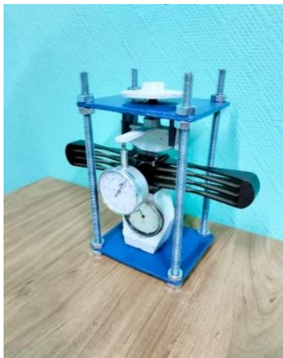
Рисунок 1 - Общий вид прибора для измерения деформации и прочности семян зерновых сельскохозяйственных культур
