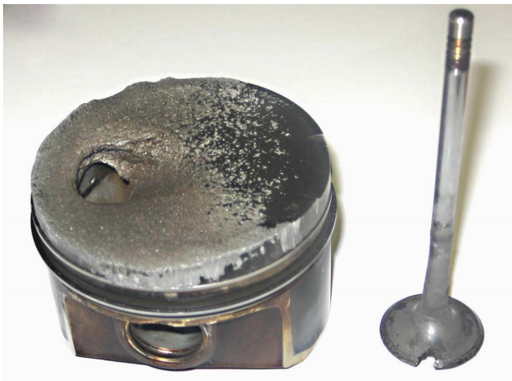
Рисунок 1 – Внешний вид разрушенного в результате преждевременного воспламенения топливовоздушной смеси поршня двигателя и клапана
