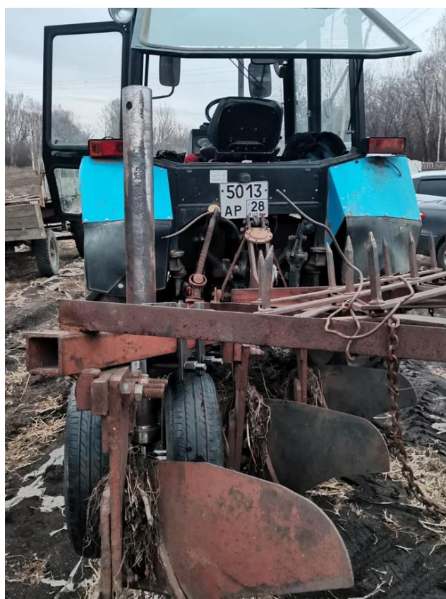
Рисунок 4. Трактор МТЗ 82.1 и плуг ПЛН-3-35 с предлагаемым колёсным модулем на хозяйственных работах в КФХ Росинка Благовещенского района Амурской области
