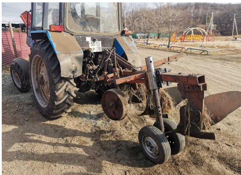
Рисунок 3. Опытное устройство - колёсный модуль для навесного сельскохозяйственного почвообрабатывающего орудия в конструкции МТА (трактора МТЗ 82.1 и плуг ПЛН-3-35) на хозяйственных работах в КФХ Росинка Благовещенского района Амурской области
