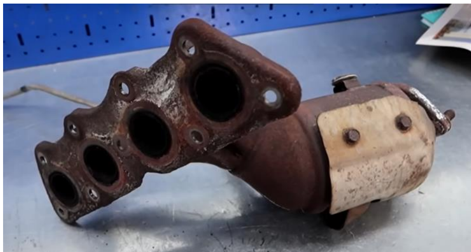
Рисунок 2 – Внешний вид катализатора автомобиля Kia Rio двигателя объемом 1600 см 3
