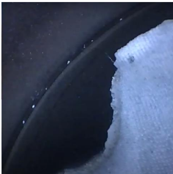
Рисунок 3 – Внешний вид разрушенных керамических сот каталитического нейтрализатора
