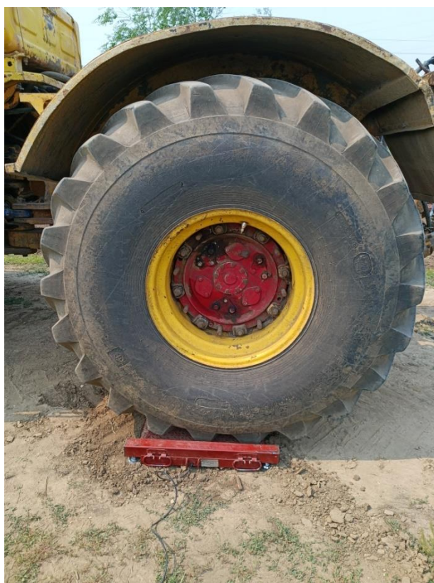
Рисунок 3 – Измерение вертикальной нагрузки, приходящейся на движители трактора К-700А
