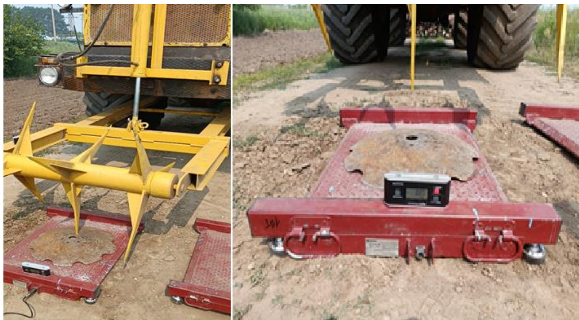
Рисунок 2 – Определение нагрузки на рабочий орган
