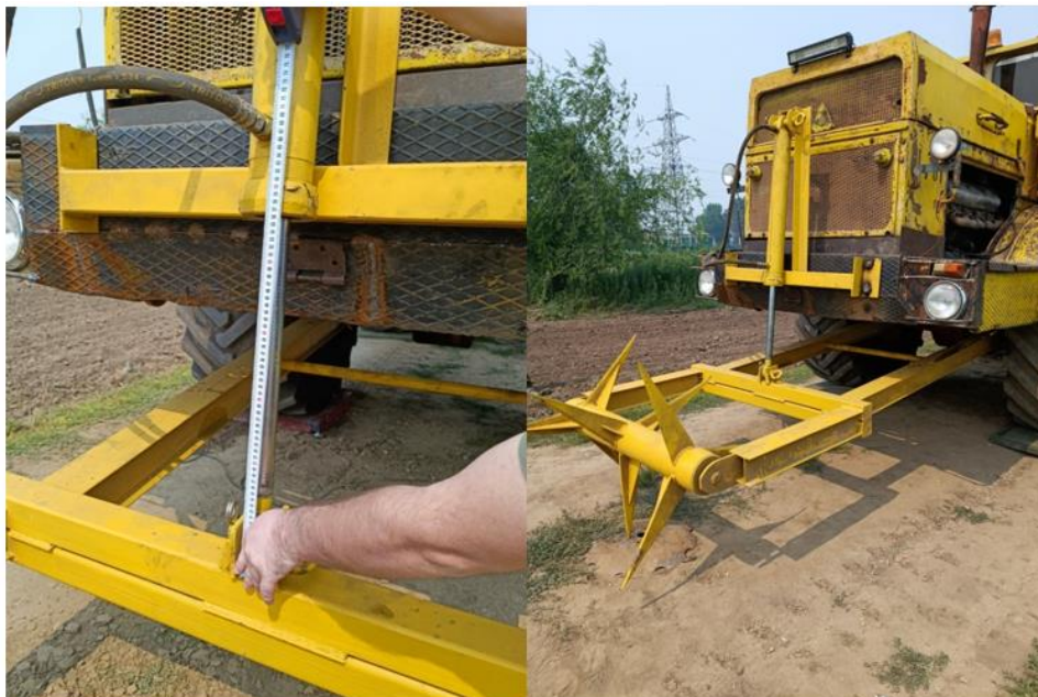
Рисунок 4 – Фрагмент определения длины выхода штока гидроцилиндра
