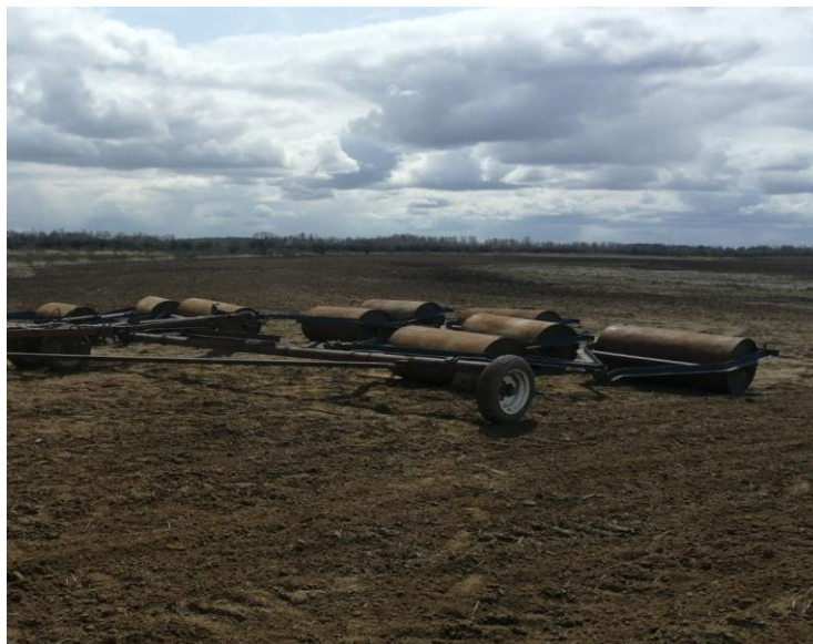
Рисунок 3 – Прикатывающий агрегат с регулируемым силовым воздействием на почву
