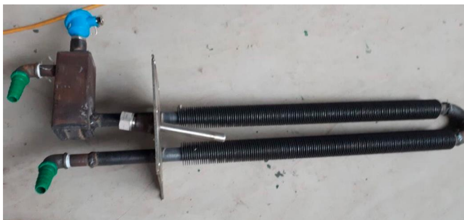
Рисунок 1 – Изготовленный теплообменный аппарат с ребристой поверхностью
