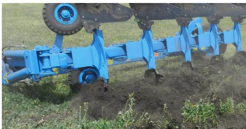
Рисунок 3 – Оборотный пятикорпусной плуг PERESVET ППО-5-35
