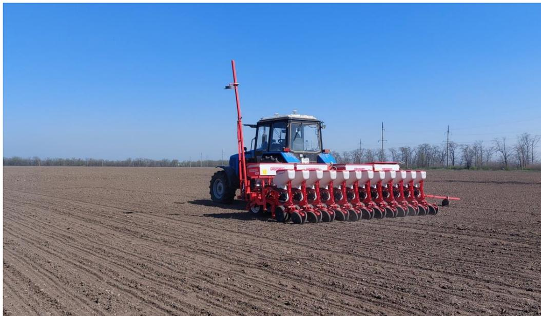
Рисунок 3 – Посев селекционного материала 12-рядной сеялкой GASPARDO MTR
