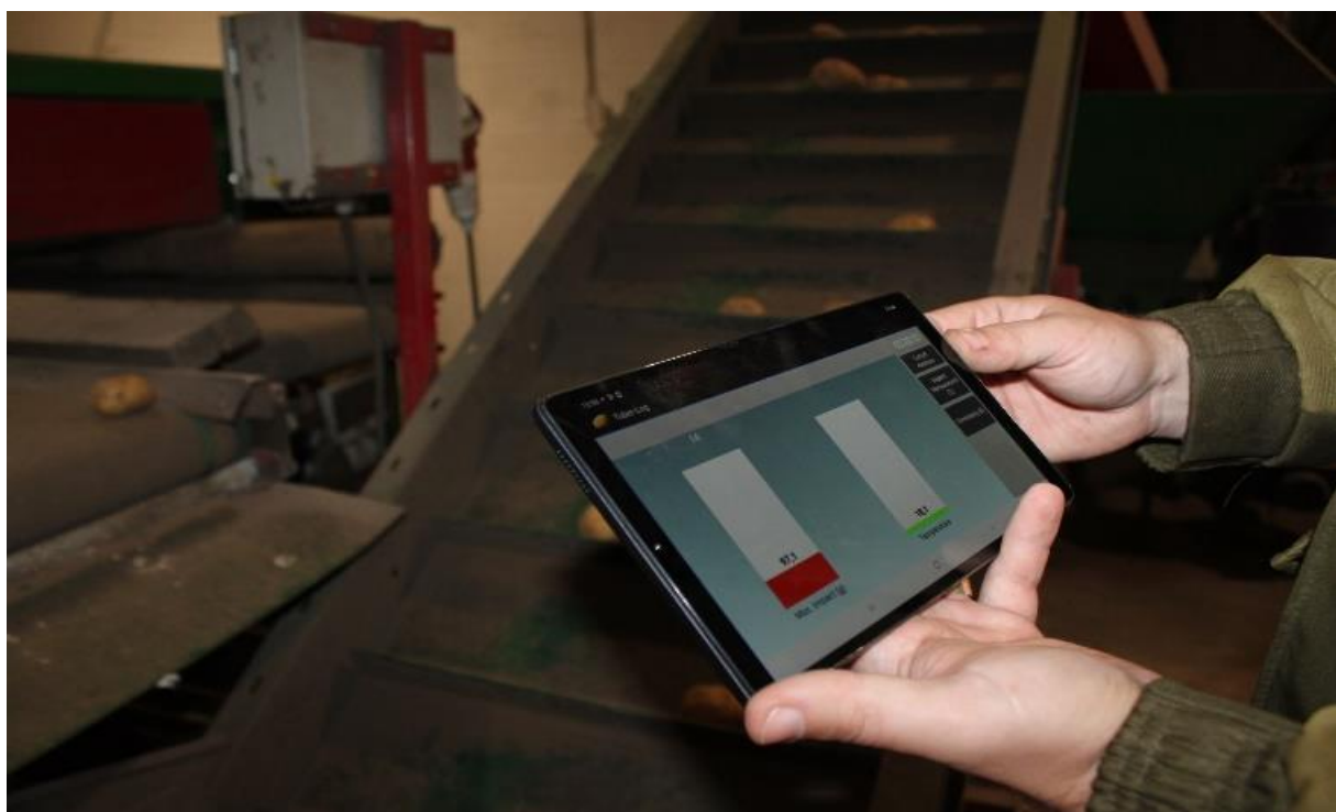
Рисунок 6. Контроль величины взаимодействия радиоклубня с элементами сортировочного комплекса на этапе послеуборочной доработки
