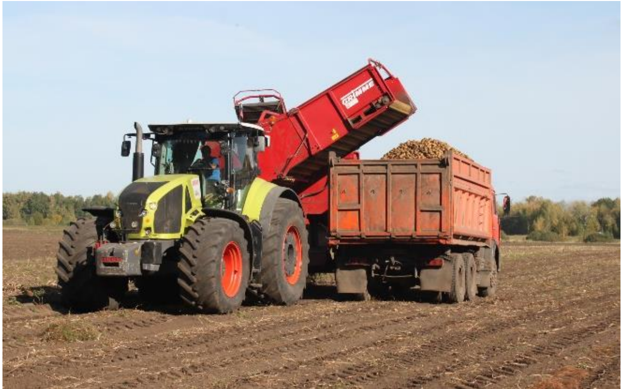
Рисунок 2. Выгрузка клубней картофеля из картофелеуборочного комбайна Grimme SE 150-60 в кузов транспортного средства
