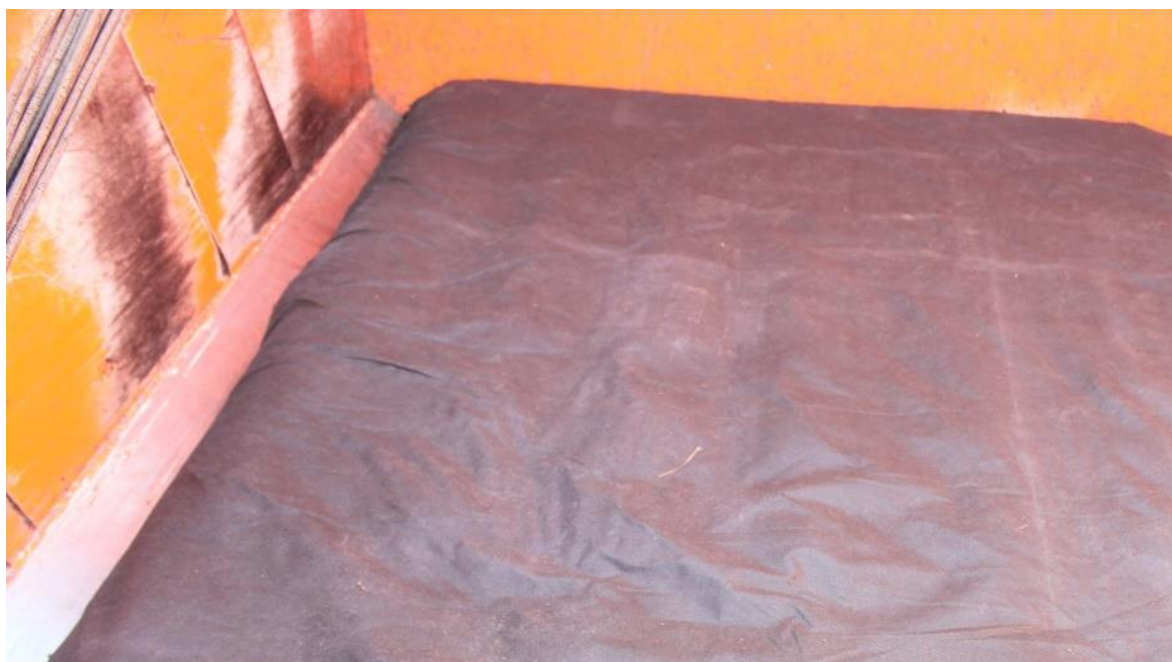
Рисунок 1. Демпфирующее устройство в кузове автомобиля КамАЗ 5320
