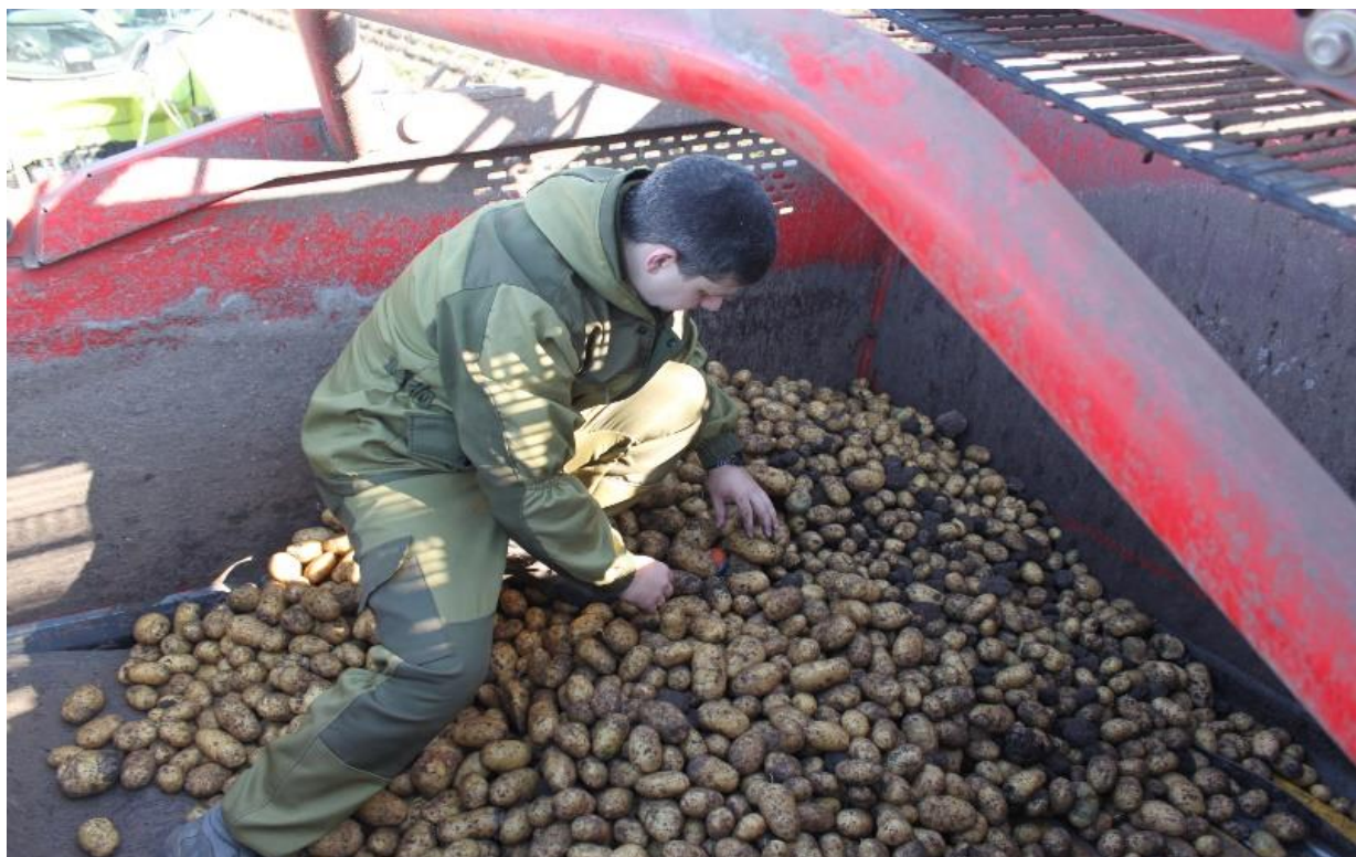
Рисунок 4. Контроль положения радиоклубня в бункере картофелеуборочного комбайна
