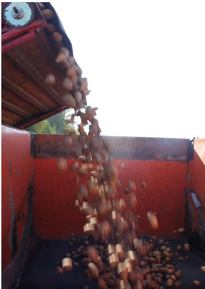
Рисунок 3. Процесс загрузки клубнями картофеля транспортного средства с надувным демпфирующим устройством
