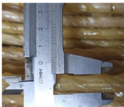
Рисунок 2. – Определение размерных характеристик арматуры СП– 12 ТУ
