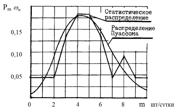
Рисунок 3 – Теоретическое и статистическое распределение потока требований на ремонт гидронасосов РСМ 8318643
