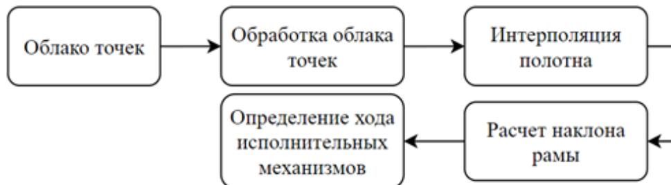
Рисунок 3 – Блок схема работы системы стабилизации кабины
