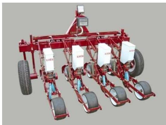
Рисунок 6 – Пневматическая овощная сеялка с электронным управлением Клен-1,8
