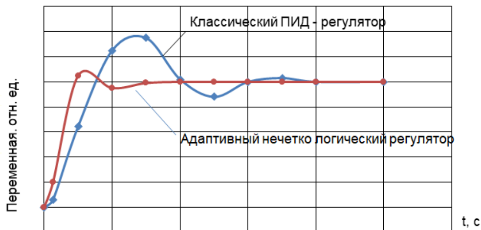
Рисунок 5 – Переходный процесс нечёткого ПИД - регулятора
